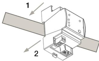
1. Hängen Sie das Gerät oben in die Hutschiene ein.
